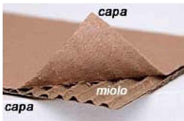
Figura 1 - Composição do papel corrugado Fonte: Onduflex, 2012.
