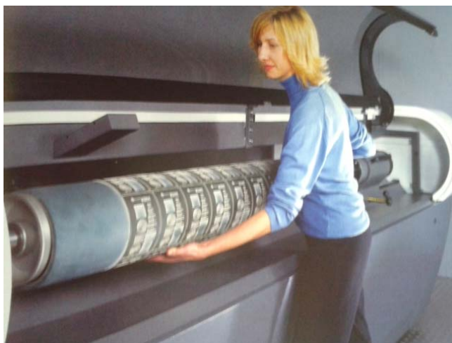
Figura 7 – queima de clichê a laser Fonte: Manual pratico da flexografia, 2007.
