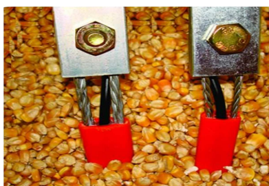
Figura 14 - Detalhe do sensor de temperatura Fonte: CASEMG (2013)
