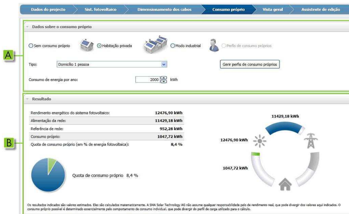
Figura 45 - Etapa consumo próprio, prog. Sunny Design Fonte: Manual de utilização do SUNNY DESIGN v.2.20, SMA, 2012
