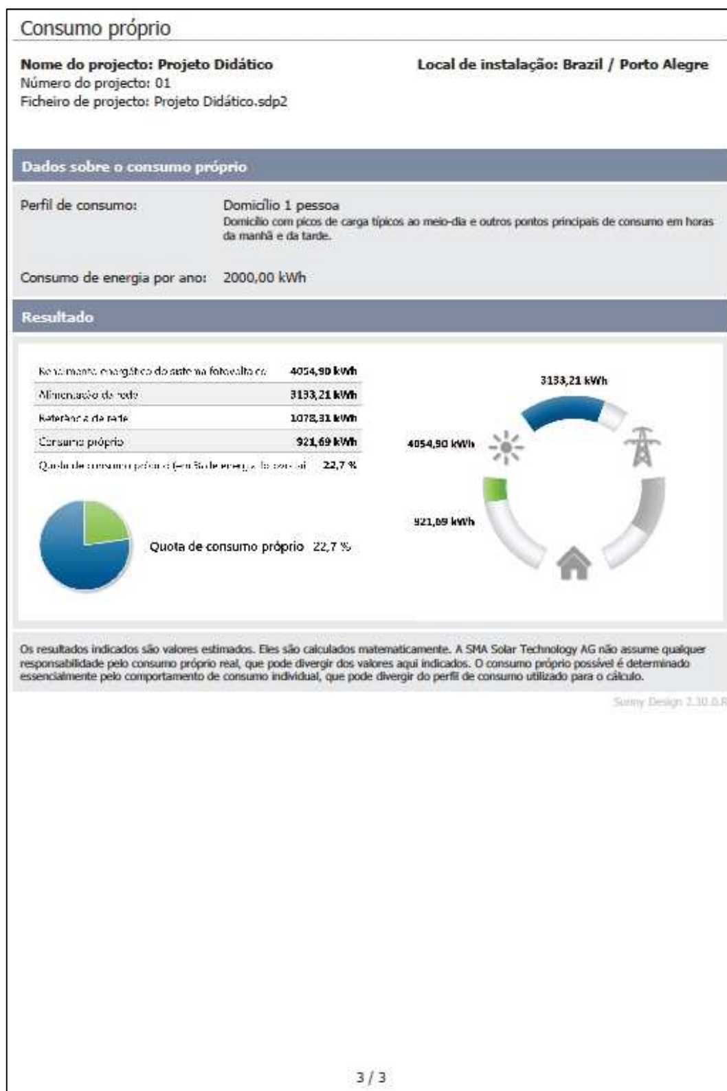
Figura 49 - Relatório do consumo próprio, prog. Sunny Design Fonte: Programa SUNNY DESIGN v.2.30, SMA, 2013
