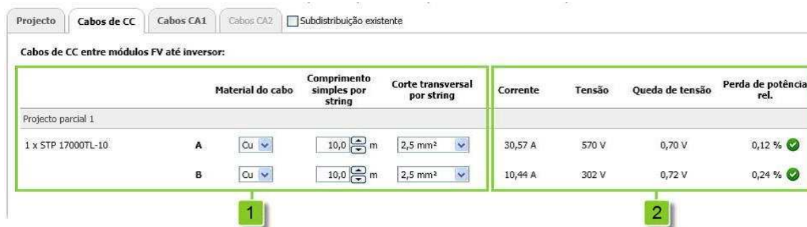
Figura 43 - Aba cabos de CC, etapa dimensionamento dos cabos, prog. Sunny Design Fonte: Manual de utilização do SUNNY DESIGN v.2.20, SMA, 2012
