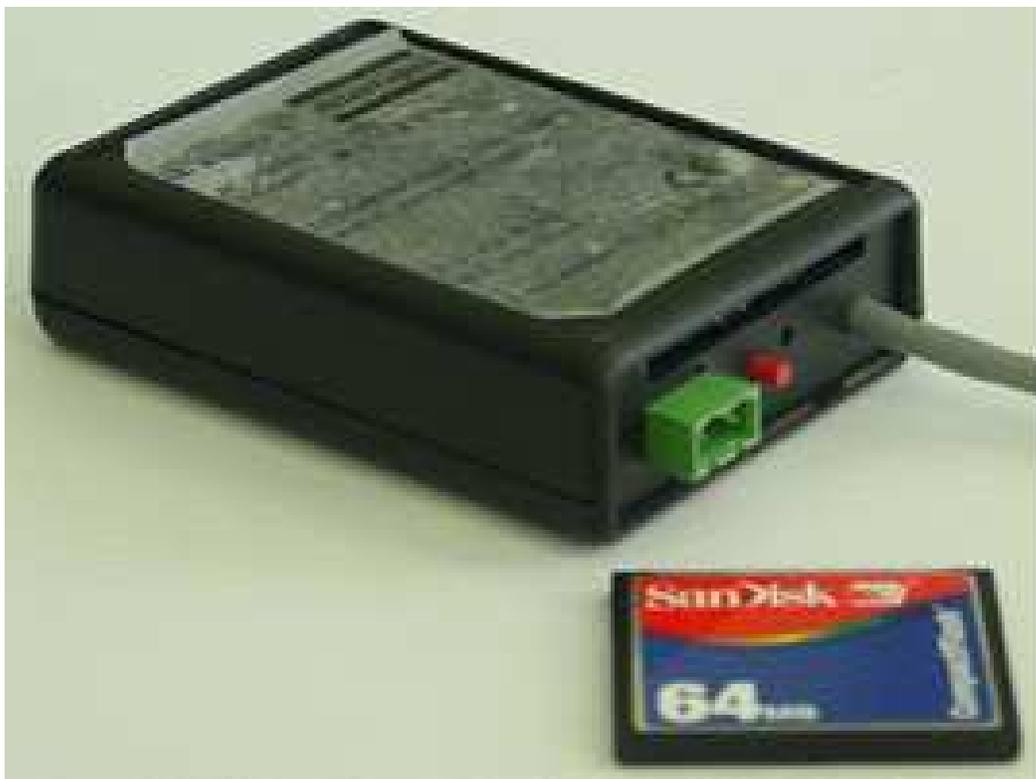
Figura 31 – Il Track - Equipamento de medição de corrente.
