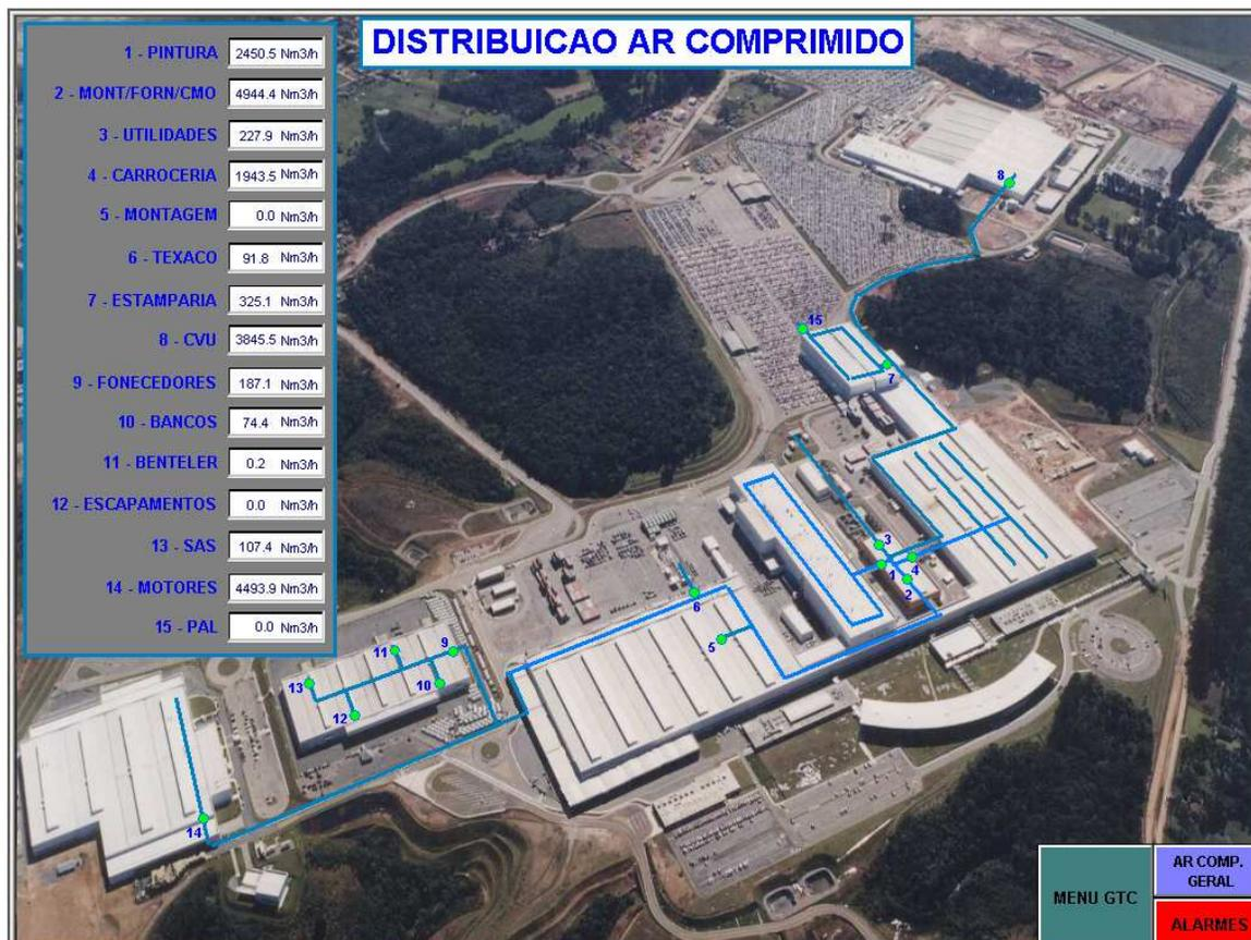
Figura 25 – Sistema de Distribuição de Ar Comprimido da Renault do Brasil
