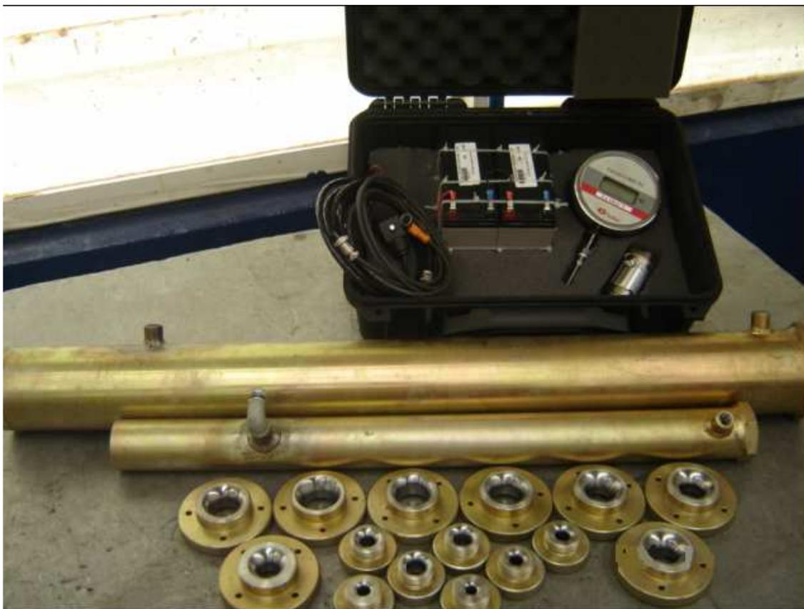
Figura 22 – Ferramenta de Medição de Rendimento dos Compressores
