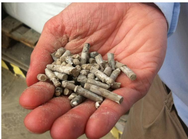
**Fotografia 3 - Poliuretano após a retirada do agente de expansão**
