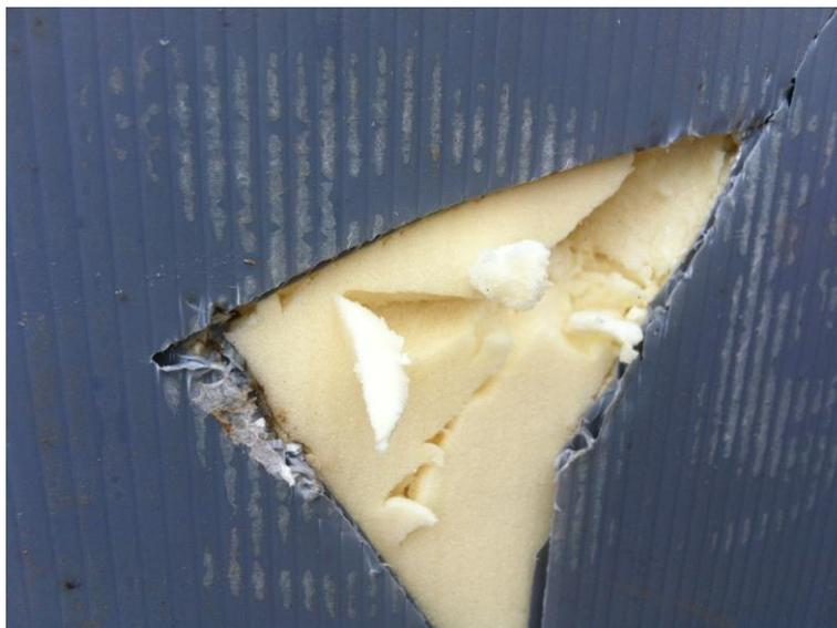
**Fotografia 2 - Isolamento térmico de poliuretano de um refrigerador**
