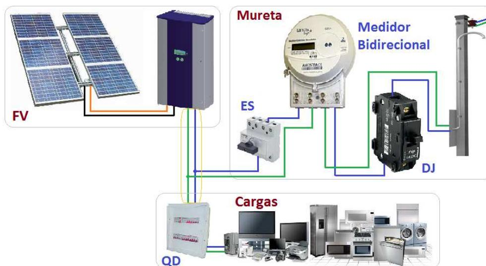
Figura 21 - Exemplo de um SFCR monofásica de BT no sistema de compensação de energia de acordo com a Resolução Normativa ANEEL 482/2012.
