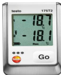
Figura 5: "LOGGER" responsável pelos registros de temperatura. Fonte: Autoria própria.
