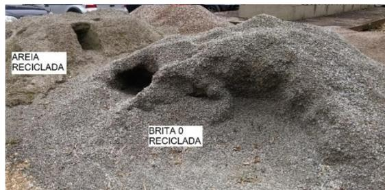
Figura 34: Pilhas de agregados reciclados
