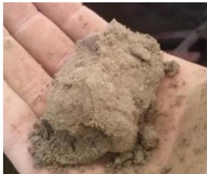
Figura 37: Consistência de concretos secos
