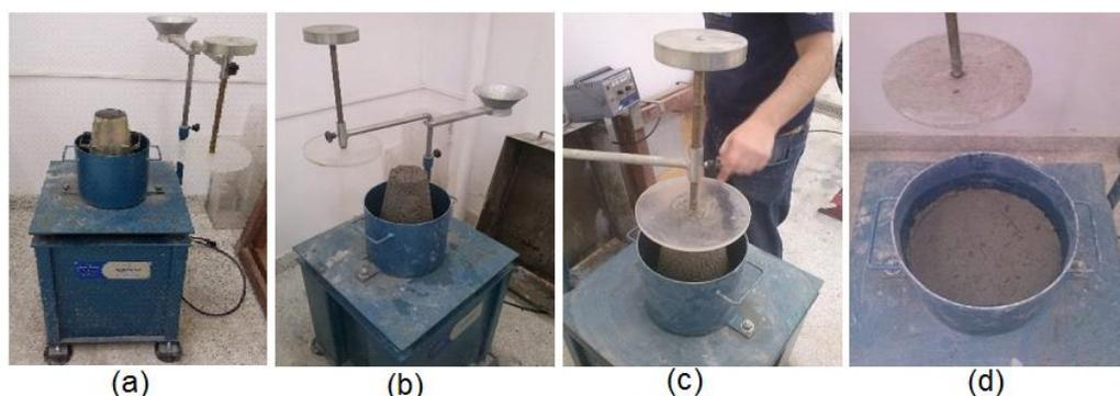
Figura 40: Consistômetro de “VeBe”: equipamento e procedimento
