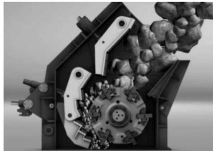
Figura 5: Britador de impacto de eixo horizontal: corte
