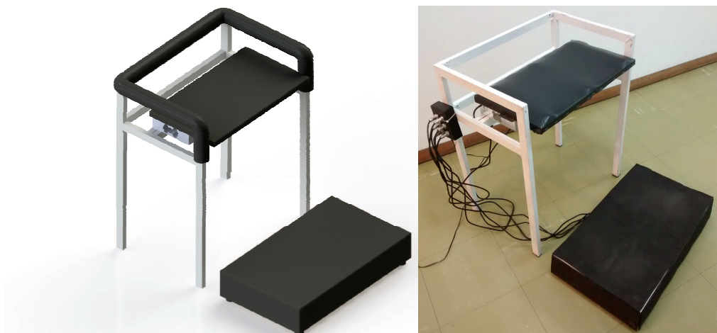
Figura 4.1 – Simulação e protótipo das plataformas de força fabricado. Fonte: autoria própria.
