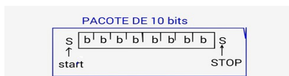
Figura 37 – Estrutura do byte enviado pela Serial Fonte: Autoria própria
