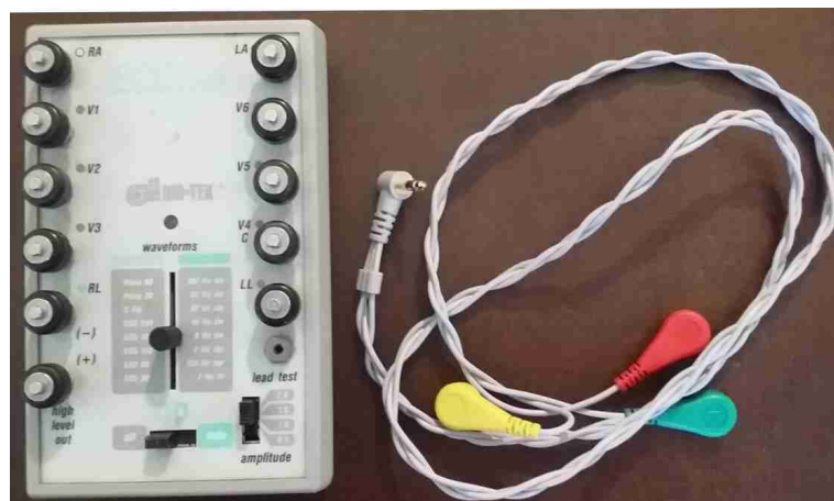
Figura 30 – Simulador de sinais de ECG da Bio-Tek modelo ECG-Plus. Fonte: Autoria própria
