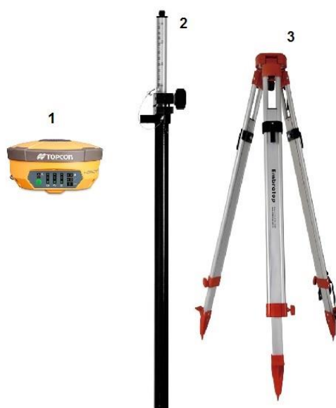
Figura 13 – Receptor GNSS Hiper V, Bastão Telescópico e Tripé Alumínio Fonte: Adaptado Embratop (2017)
