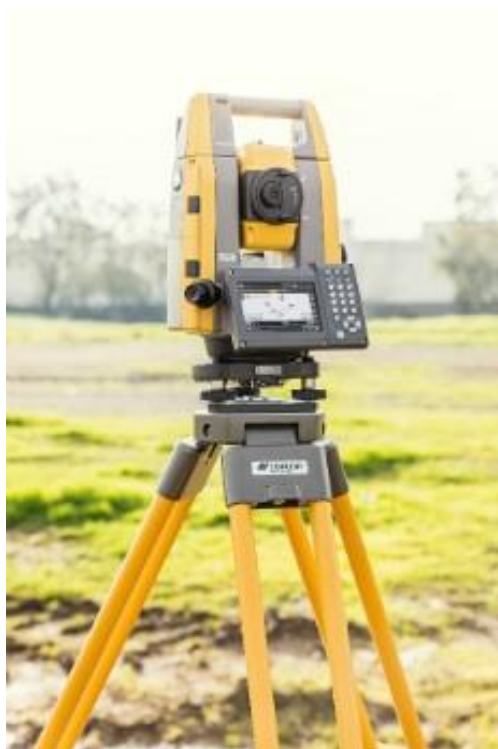
Figura 4 – Estação Total Fonte: Geoconnexion (2017)
