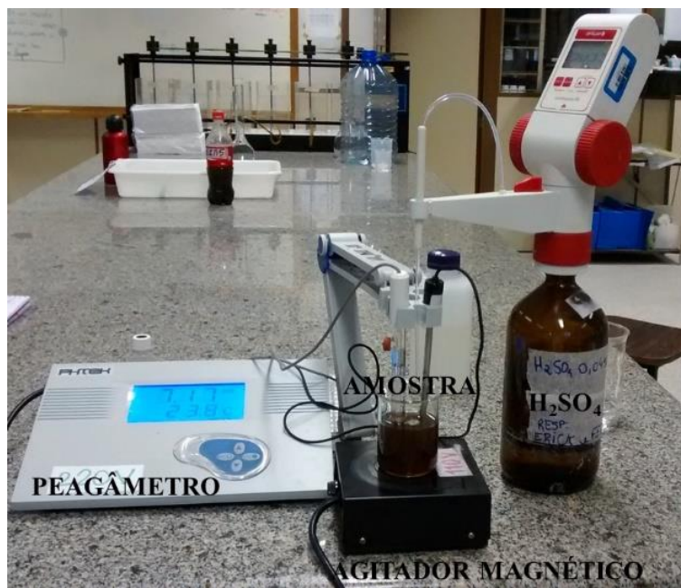
Figura 22 – Conjunto de equipamentos utilizados para análise de alcalinidade
