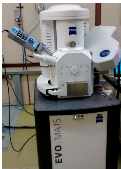
Figura 34 – Conjunto de equipamentos para análise de MEV e EDS
