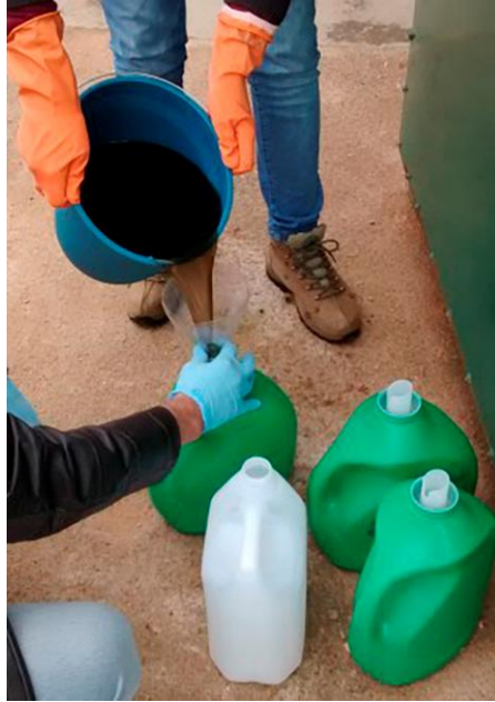
Figura 18 – Transferência do lixiviado para os galões de 5 litros
