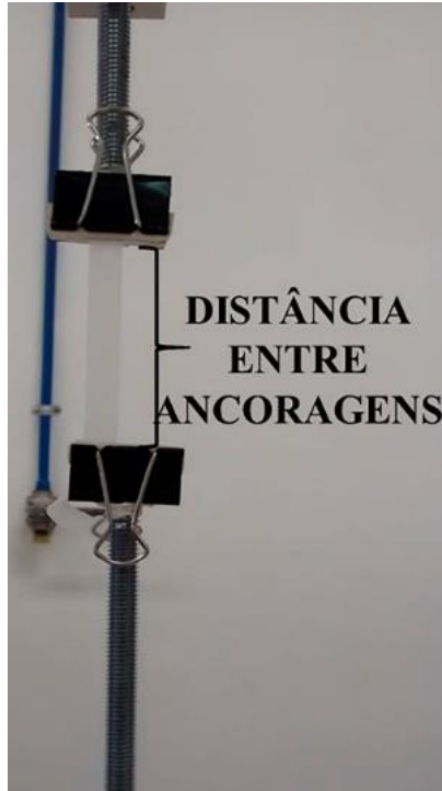
Figura 31 – Distância entre as ancoragens
