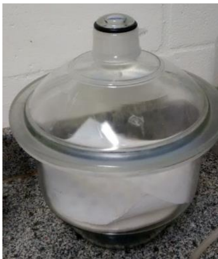
Figura 33 – Dessecador utilizado para a retirada da umidade das tiras plástico mole
