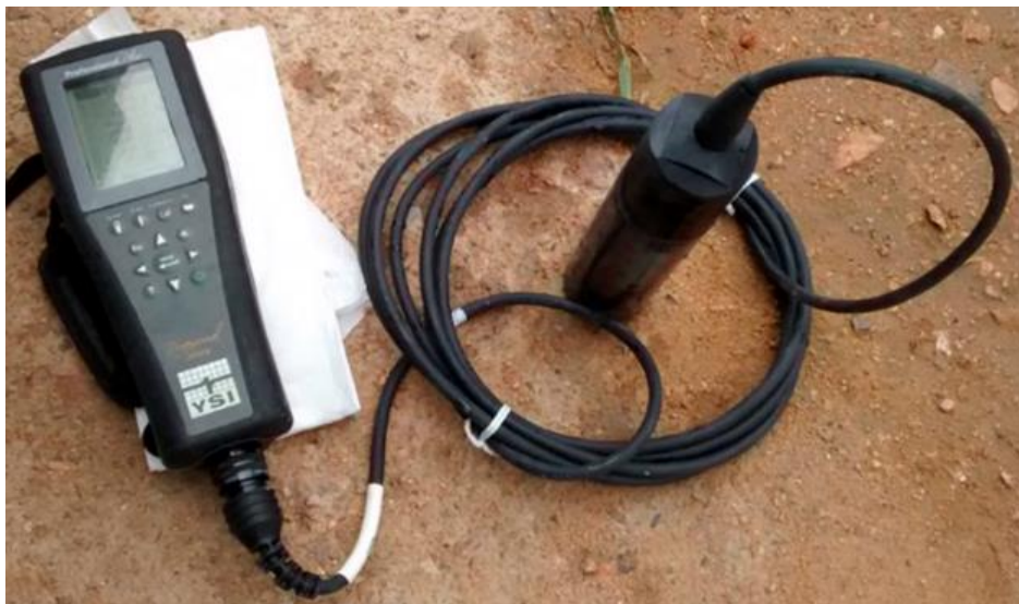
Figura 19 – Equipamento professional plus handheld multiparameter utilizado para medir pH
