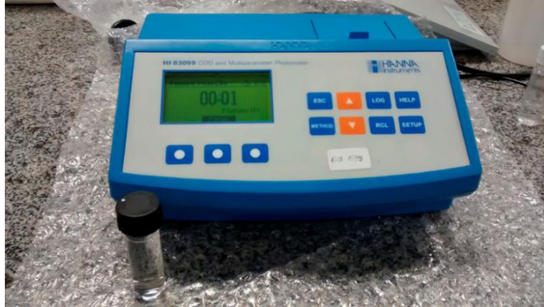
Figura 24 – Equipamento utilizado para análise de nitrogênio amoniacal e fósforo total Fonte: Autoria própria
