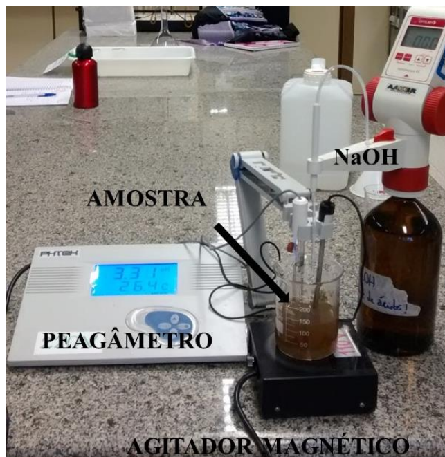
Figura 23 – Conjunto de equipamentos utilizados para análise de ácidos voláteis Fonte: Autoria própria
