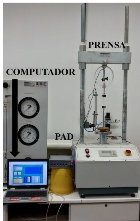
Figura 27 – Visão geral da bancada utilizada para os ensaios de tração do plástico mole
