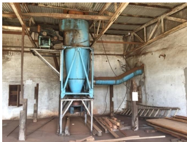
Figura 11 – Ciclone para captação da poeira.
