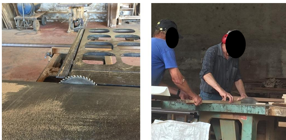
Figura 21 – Zonas de risco expostas.
