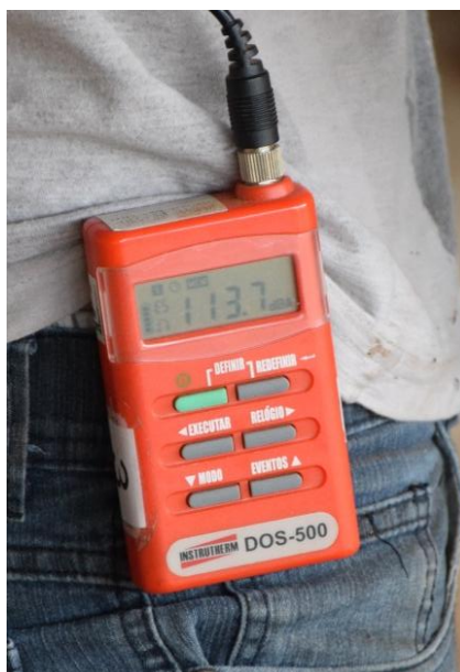
Figura 3 – Dosímetro utilizado nas medições de ruído. Fonte: A autora, 2016.
