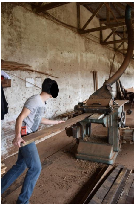
Figura 8 – Trabalhador operando a plaina. Fonte: A autora, 2016.
