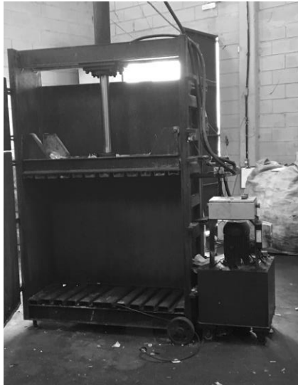
Figura 5 - Processo de enfardamento utilizando a prensa hidráulica Fonte: A autora (2017).
