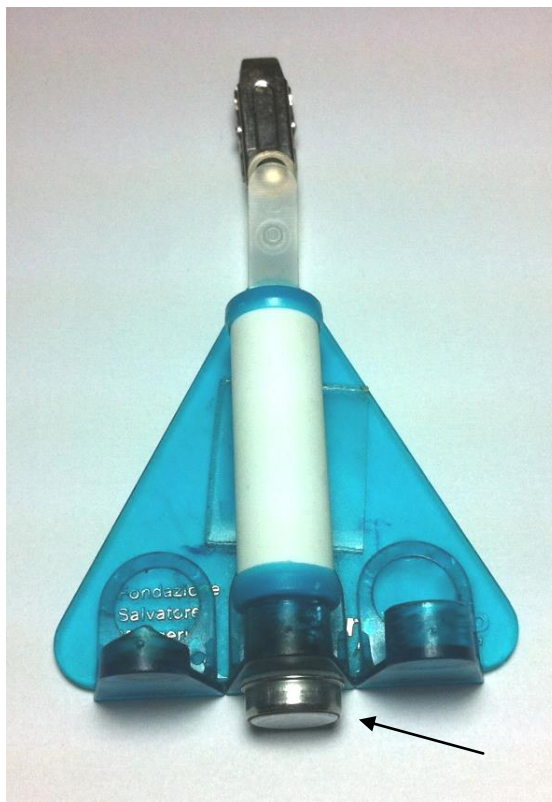
Figura 5 - Termômetro Acoplado ao Amostrador de COVs. Fonte: O autor (2001).
