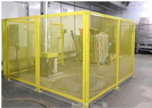
Figura 2 – Proteção fixa metálica
