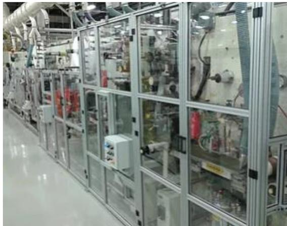
Figura 3 - Proteção fixa de policarbonato
