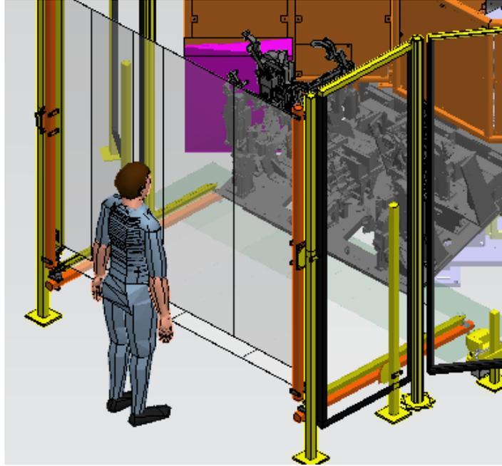
Figura 9 - Cortina de luz de segurança aplicada em estação de carregamento.
