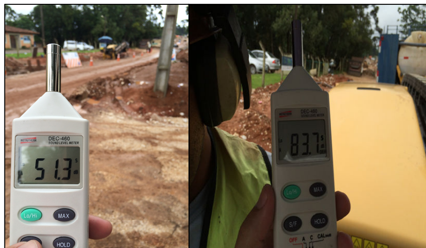
Figura 9 – Medição de ruído emitido pelo equipamento Navigator D36X50 Fonte: (Autor, 2015)
