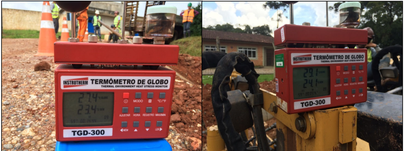
Figura 16 – Medição IBUTG Fonte: (Autor, 2015)
