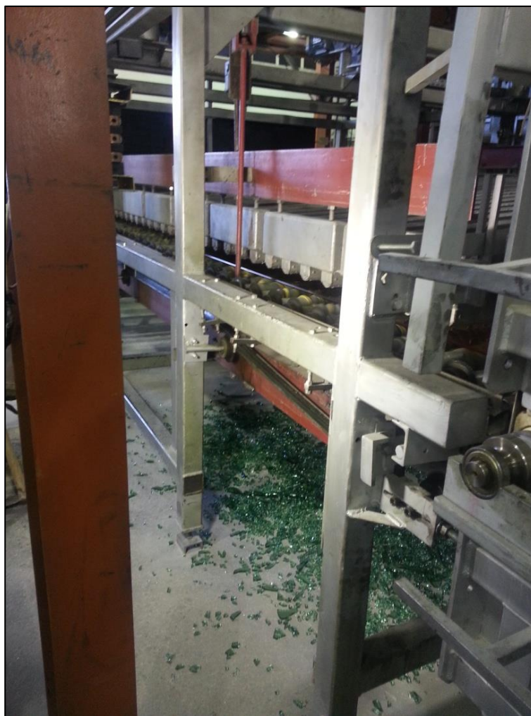
Figura 4 – Ponto 3 - Retirada de peças quebradas do forno Fonte: O Autor, 2014.
