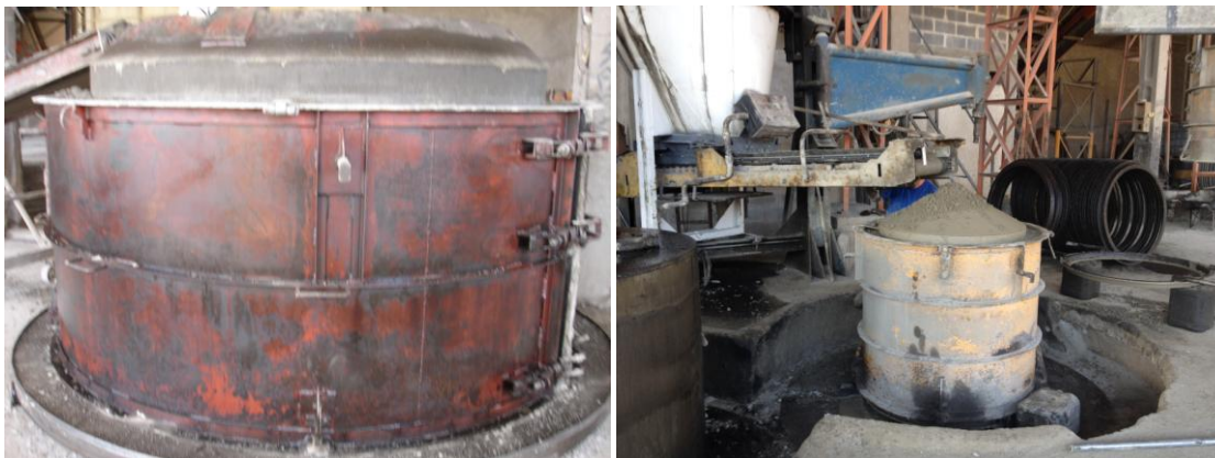
Figura 5 – Equipamentos de Vibrocompressão Fonte: A Autora, 2015.
