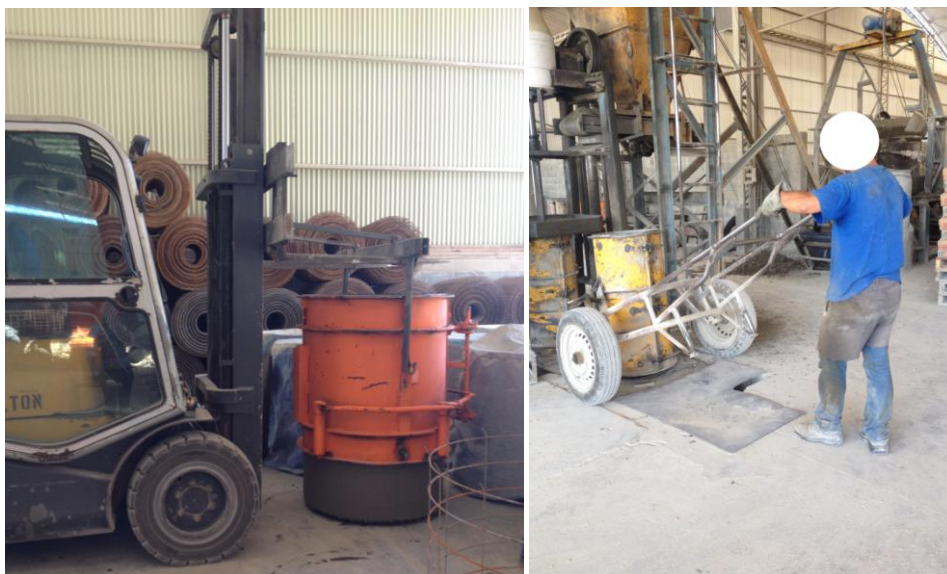
Figura 7 – Equipamentos para Transporte dos Tubos Fonte: A Autora, 2015.
