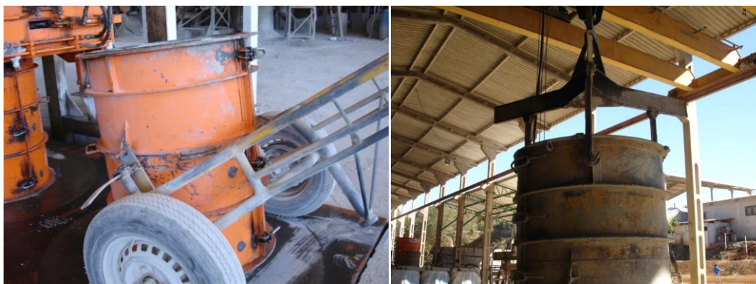
Figura 6 – Equipamentos para Transporte dos Tubos Fonte: A Autora, 2015.
