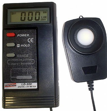
Figura 17. Luxímetro Instrutherm LD-200.
