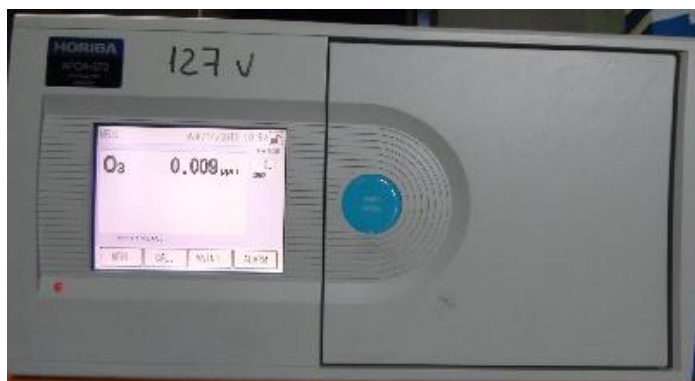
Figura 13: Medidor de ozônio HORIBA APOA-370 Fonte: Próprio autor
