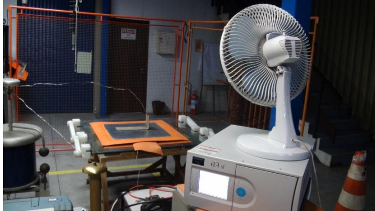
Figura 25: Teste com o ventilador para aumentar a dispersão do ozônio no ambiente Fonte: Próprio autor
