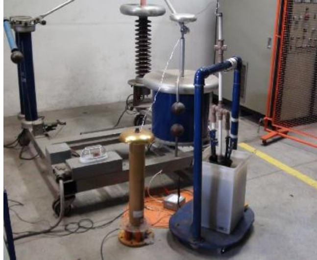
Figura 16: Arranjo para ensaio de luvas isolantes Fonte: Próprio autor
