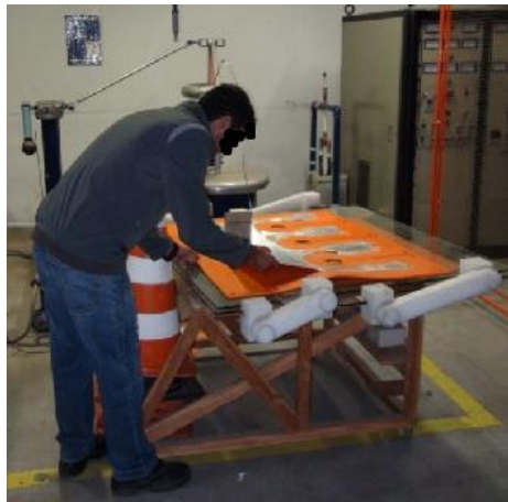
Figura 21: Operador preparando o ensaio de mantas isolantes Fonte: Próprio autor
