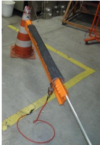
Figura 19: Cobertura de condutor montada para o ensaio Fonte: Próprio autor
