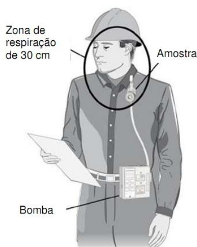
Figura 9: Elementos de um sistema de amostragem Fonte: OHTA - Occupational Hygiene Training Association. (2010)
