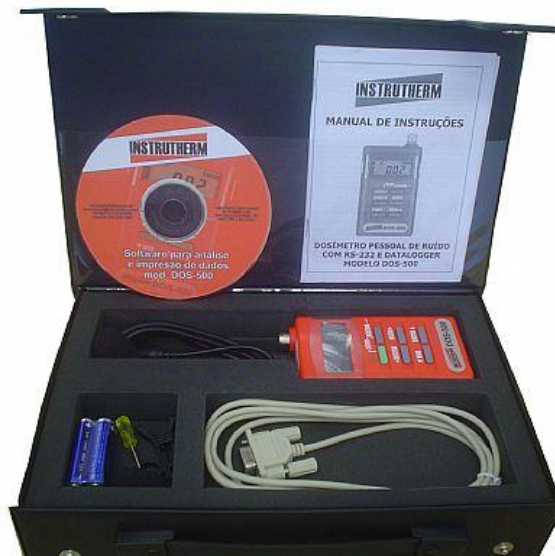
Figura 3 – Dosímetro de Ruído Digital Portátil DOS-500
