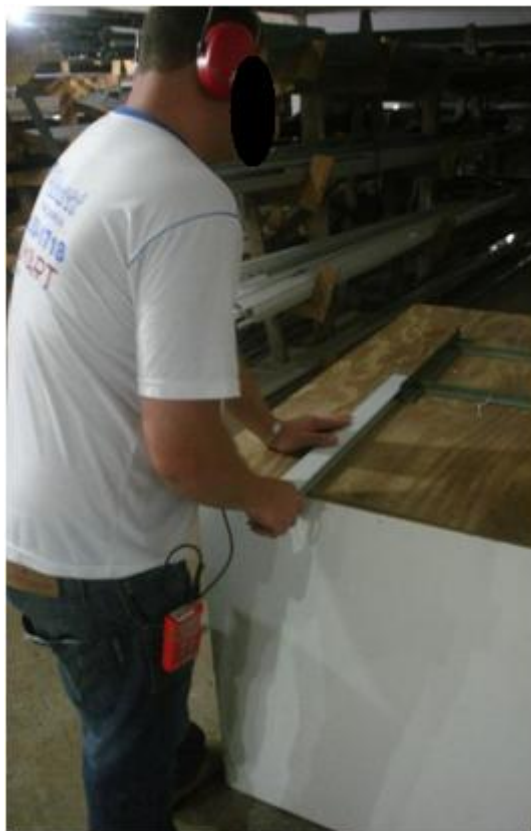
Figura 13 – Serralheiro Utilizando a Serra Circular de Bancada 3
