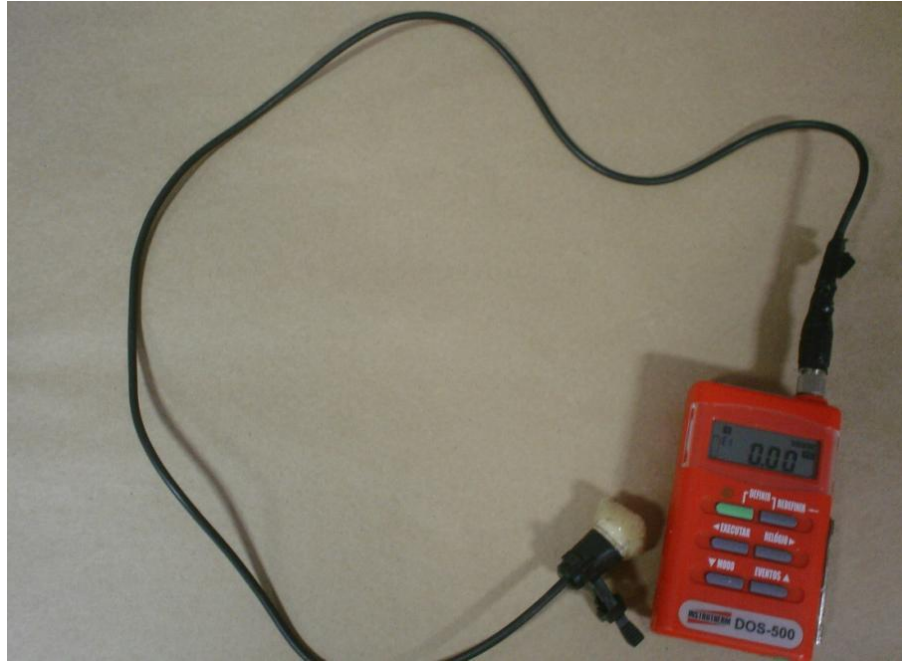
Figura 6 – Dosímetro DOS-500 Utilizado para a Realização das Medições
