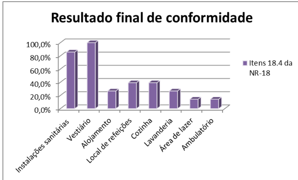
Figura 28: Grau de cumprimento do disposto no item 18.4 da NR-18. Fonte: O autor (2012).
