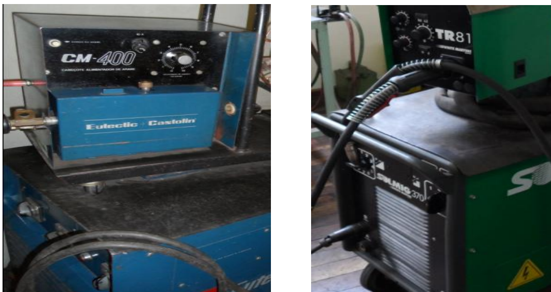
Figura 9 – Painéis das máquinas de soldagem
