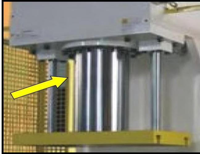
**Figura 20** - Cilindro hidráulico.
