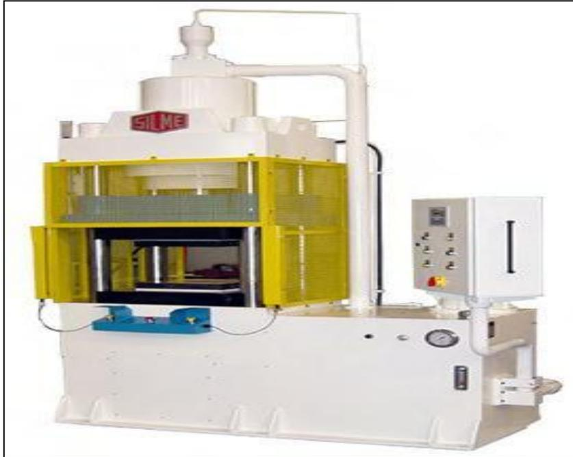
**Figura 10** - Cortina de luz instalada conjugada com comando bi-manual e com enclausuramento.
