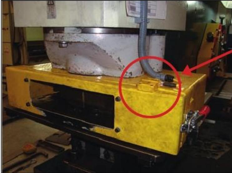
**Figura 4-** Enclausuramento da zona de prensagem, frestas de passagem da peça.
