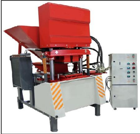
**Figura 2** - Proteção Fixa em Prensas Ecológicas por Enclausuramento.
