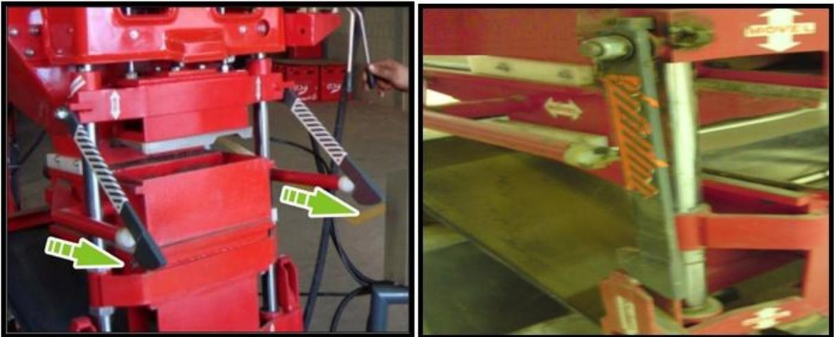
**Figura 26** – Braço Mecânico da prensa hidráulica
