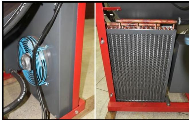
**Figura 23** - Sistema de arrefecimento.
