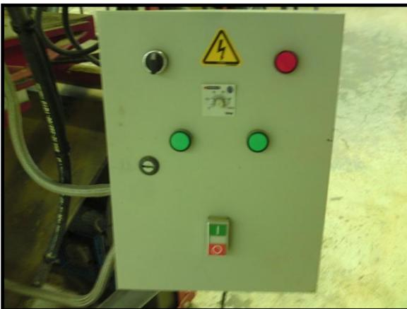
**Figura 27** - Painel Elétrico da Prensa Hidráulico
