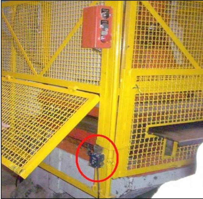
**Figura 3** - Proteções Móveis por enclausuramento da zona de prensagem e intertravadas.
