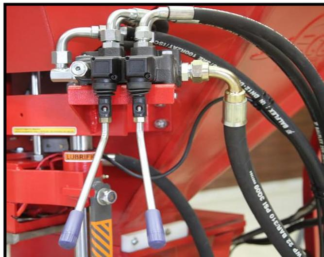
**Figura 19** - Comando Hidráulico.
