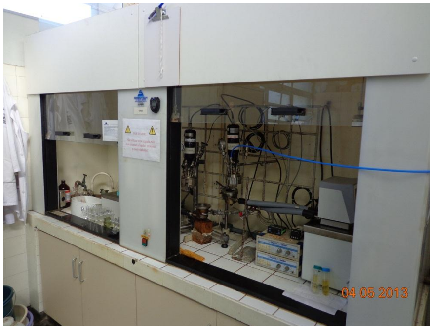
Figura 10 – Capela do local ocupado por um par de reatores de bancada e seus respectivos banhos termostáticos.
