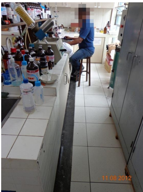
Figura 6 – Bancada não proporciona boa posição ao trabalhador (I); Resíduo que pode ser lançado no meio de trabalho e também a evidência do não uso de EPI (II).
