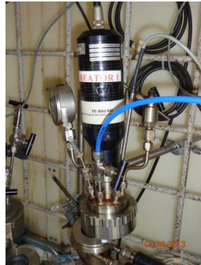
Figura 5 – Materiais obstruindo saída e também desrespeitando o afastamento mínimo de 50 cm da lateral do prédio (I); Vaso de pressão sem placa de identificação (II);
