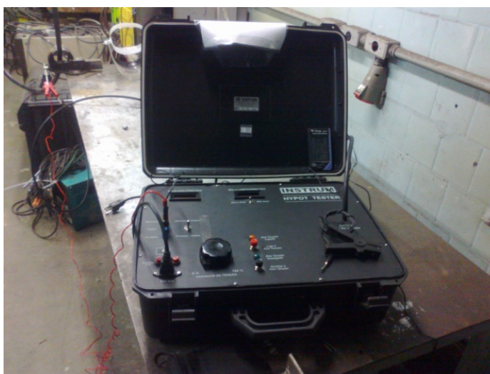
Figura 19– Equipamento Hipot instalado em bancada do canteiro, antes do ensaio. Fonte: Própria, 2012.
