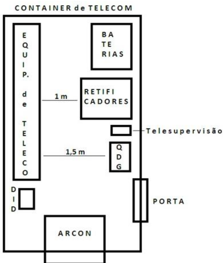
Figura 14 – Container normalmente utilizado em telecomunicações. Fonte: Própria.
