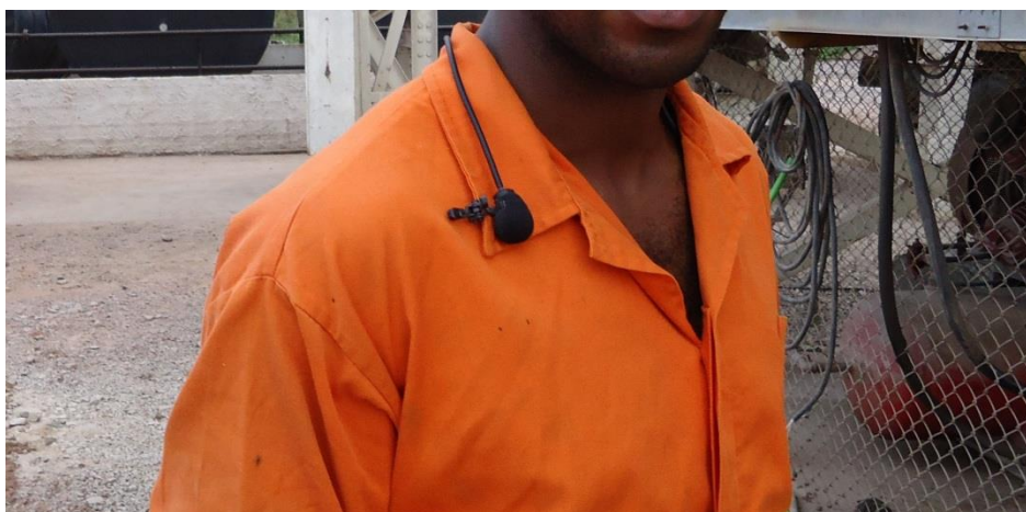
FIGURA 7 - LOCALIZAÇÃO DA POSIÇÃO DO MICROFONE DO DOSÍMETRO DE RUÍDO.
