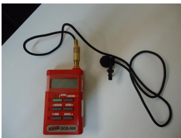
FIGURA 5 - DOSÍMETRO DE RUÍDO UTILIZADO NAS AVALIAÇÕES
