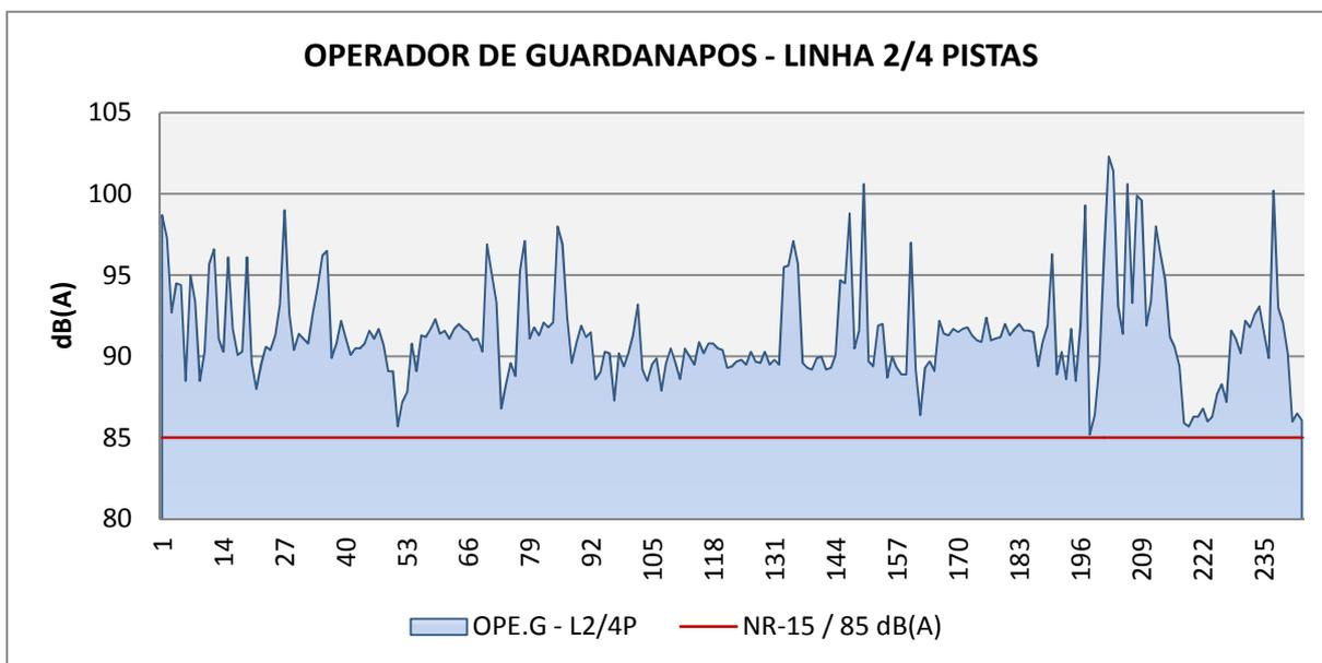
**Figura 22: Dosimetria de ruído completa - Operador de Guardanapos L2/4P - 1º Turno.**
