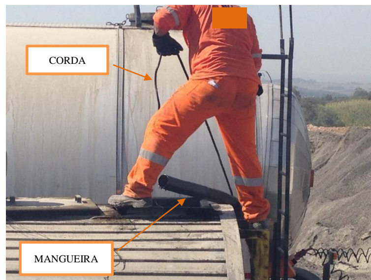
Figura 45 – Risco de queimadura pela a mangueira. Fonte: A autora (2014)
