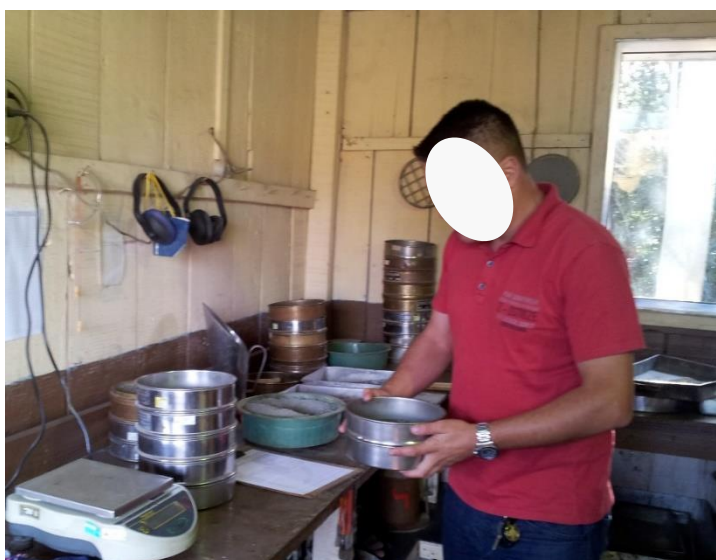
Figura 83 – Ensaio de Análise Granulométrica Fonte: Alves (2012)
