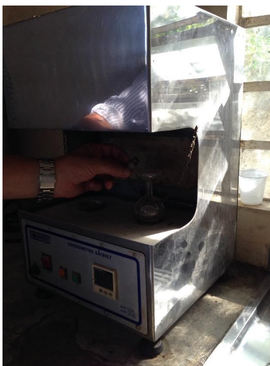
Figura 82 – Retirada da tampa do Viscosímetro de Saybolt Furol – Risco Físico
