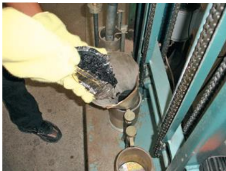
Figura 18 – Colocação da mistura no molde Fonte: BERNUCCI et al. (2010)
