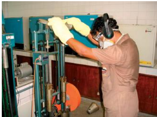
Figura 22 – Compactação da mistura com soquete de Marshall 75 golpes de cada lado.
