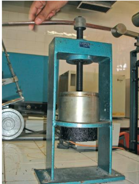
Figura 23 – Extração do corpo-de prova do molde Fonte: BERNUCCI et al. (2010)
