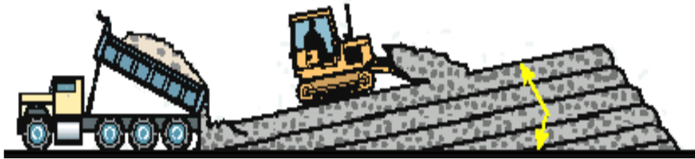
Figura 2 – Inclinação do armazenamento dos agregados Fonte: TEREX (2011)
