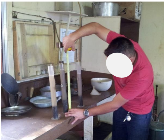
Figura 85 – Ensaio de Equivalente de Areia – Risco ergonômico e químico Fonte: Alves (2012)
