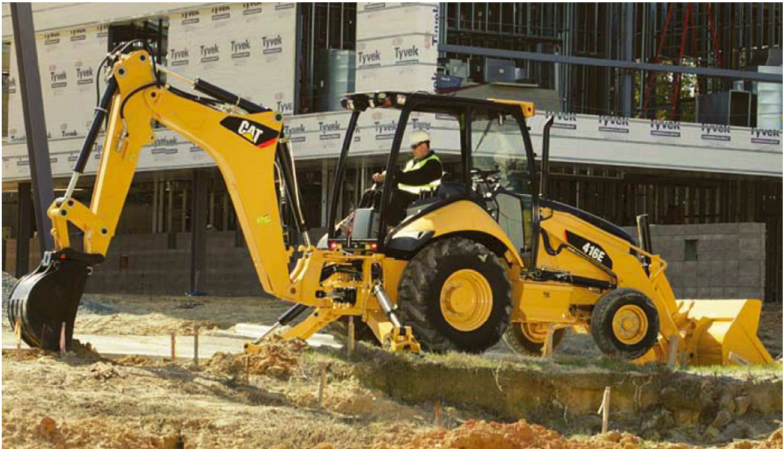
Figura 10 - Retroescavadeira Caterpillar modelo 416E Fonte: Caterpillar BR (2008).
