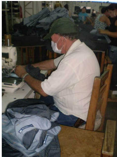
Figura 13 - Trabalhador do setor de Costura utilizando protetor auditivo e máscara respiratória. Fonte: A autora (2014).
