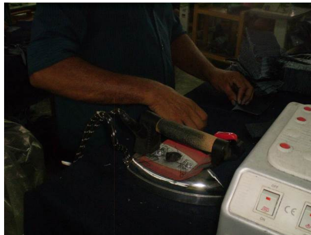
Figura 15 - Falta do uso de EPI no setor de Passadoria. Fonte: A autora (2014).
