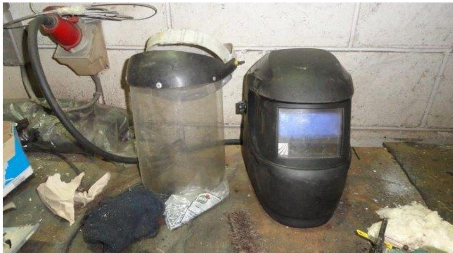
Figura 53: Visão da Bancada com EPI's sem Manutenção e Guardados Fora de Área
