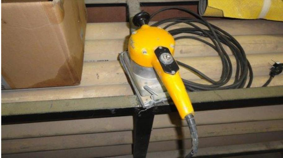
Figura 44: Ferramenta Elétrica sem Proteção e Armazenada Inadequadamente.
