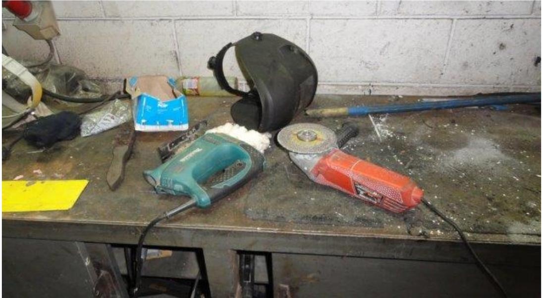
Figura 41: Ferramentas Elétricas sem Proteção e EPI's e Entulhos Misturados.
