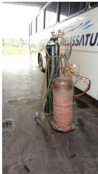
Figura 31: Equipamento de Solda Oxiacetileno.
