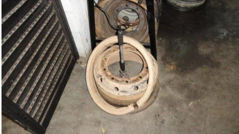
Figura 11: Equipamento para Marcar Pneus por Aquecimento.
