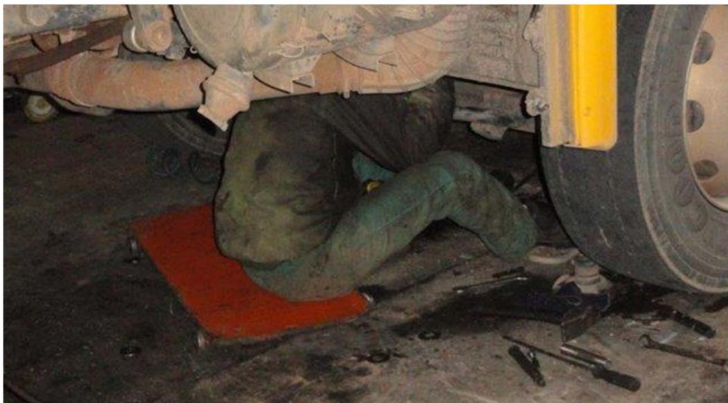
Figura 27: Trabalhador Fazendo Manutenção de Suspensão e Freios
