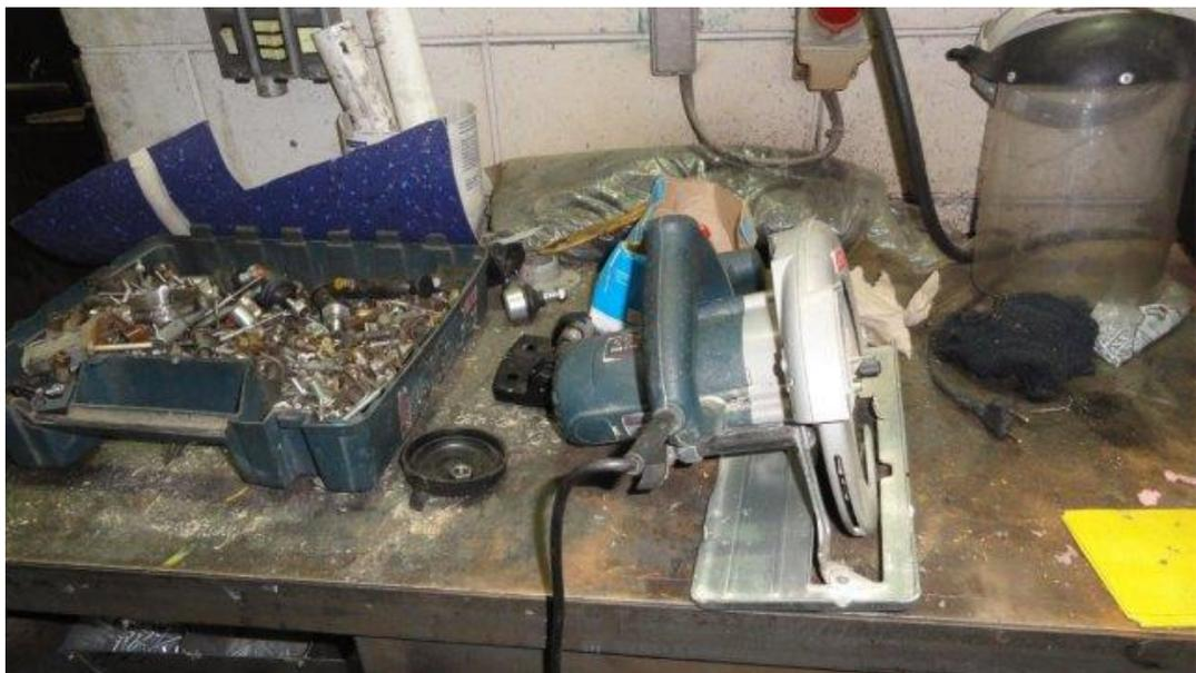
Figura 40: Ferramenta Elétrica sem Proteção e Armazenada em Local Inadequado
