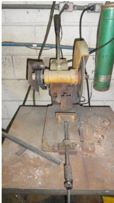
Figura 45: Ferramenta Elétrica sem Proteção
