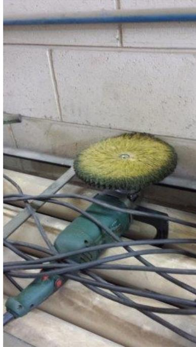
Figura 46: Ferramenta sem Proteção e Armazenada em Local Inadequado.
