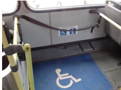
Figura 10 – Sistema de segurança inadequado identificado na linha expressa Fonte: o Autor.
