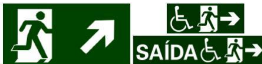
Figura 17 – Exemplos de sinalização de saída de emergência, inexistentes no local Fonte: NPT 20 (2011).
