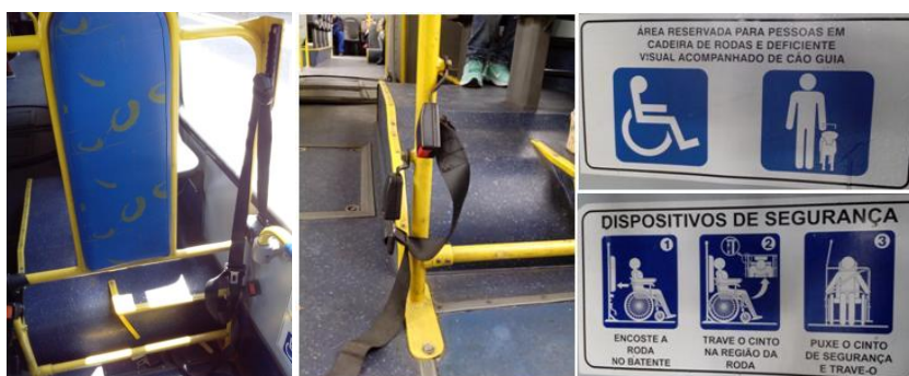
Figura 9 – Guarda-corpo, dispositivo de travamento e as orientações de manuseio do sistema de segurança Fonte: o Autor.
