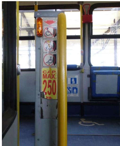
Figura 7 – Capacidade máxima de operação das plataformas elevatórias veiculares Fonte: o Autor.
