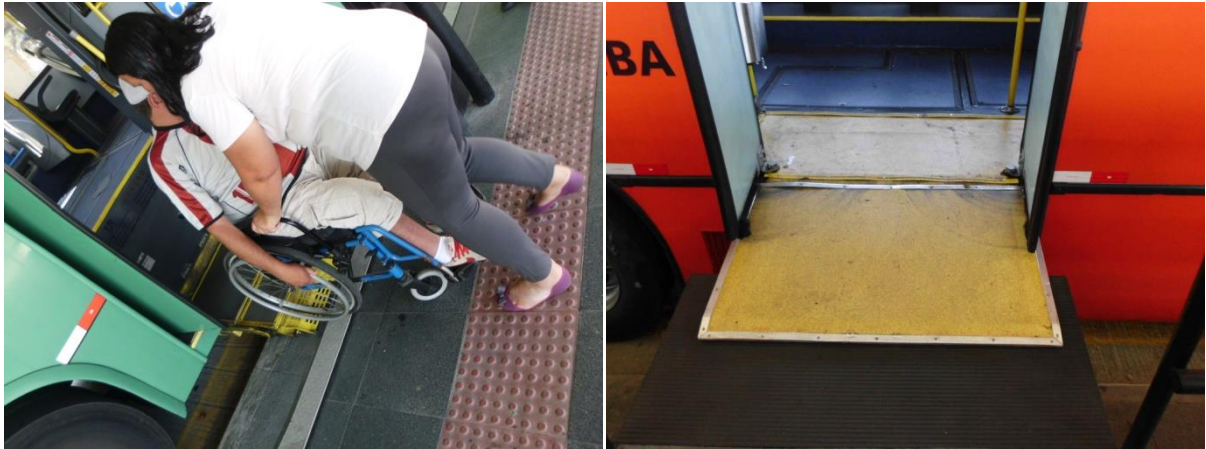
Figura 6 – Dispositivos de transposição de fronteira encontrados no local Fonte: o Autor
