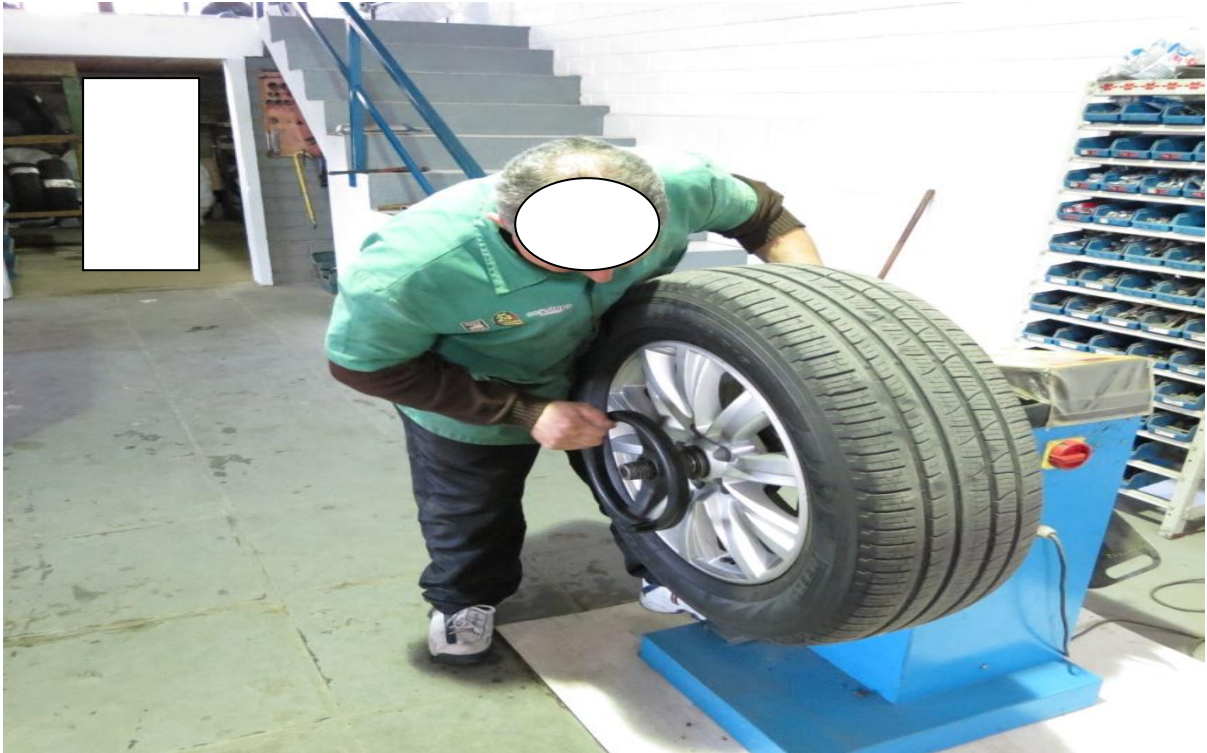
Figura 10 – Travando o conjunto roda/pneu na balanceadora. Fonte: O Autor (2013)
