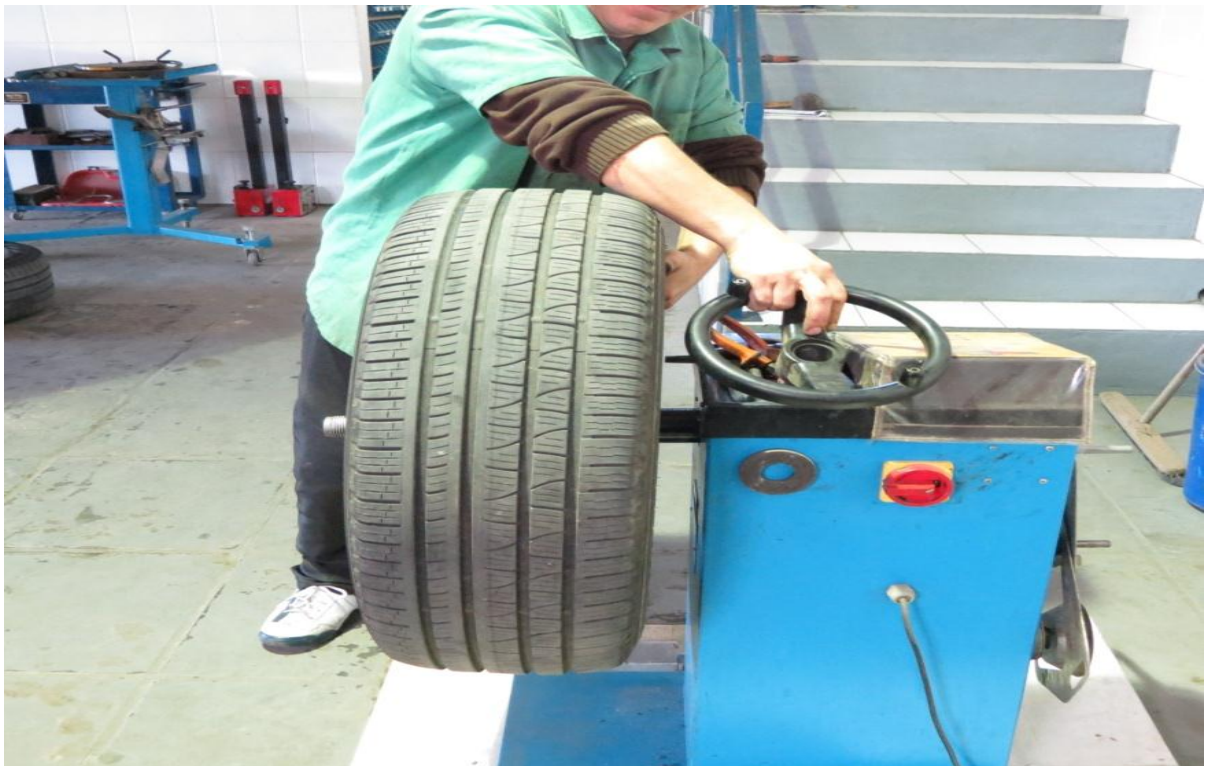
Figura 9 – Movimento para fixar a trava do conjunto roda/pneu na balanceadora Fonte: O Autor (2013)
