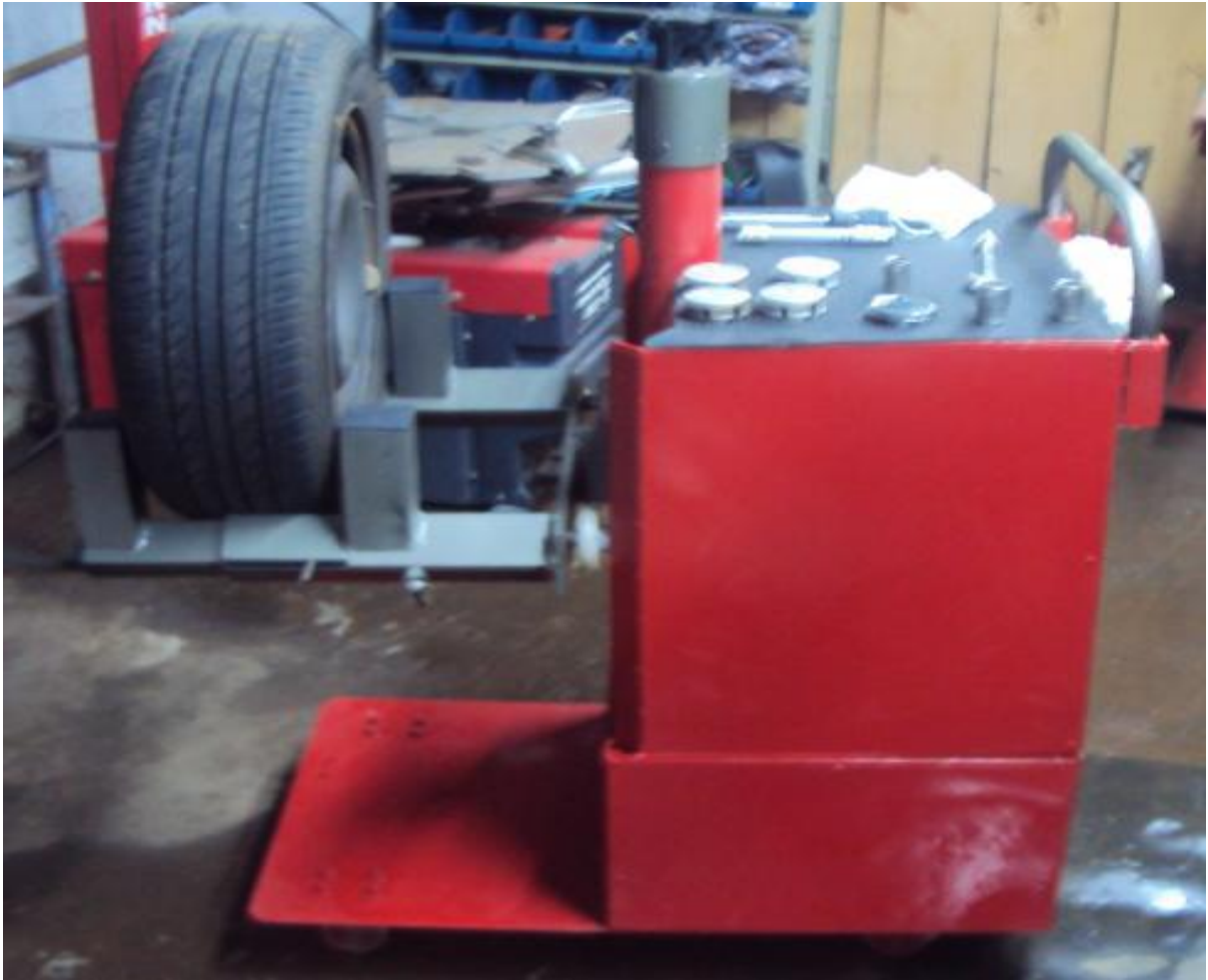
Figura 11 - Vista geral do equipamento para elevar e posicionar o conjunto roda/pneu. Fonte: Foss (2011).
