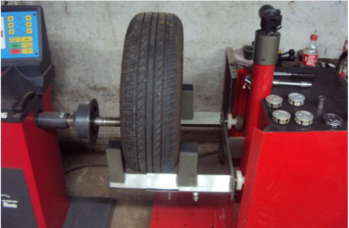
Figura 12 - Vista da elevação conjunto roda/pneu até equipamento balanceador, eliminando parcialmente o risco detectado na fase 1.
