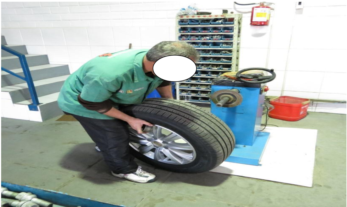
Figura 6 – Movimento de elevação do conjunto roda/pneu até a posição de acoplamento na balanceadora.
