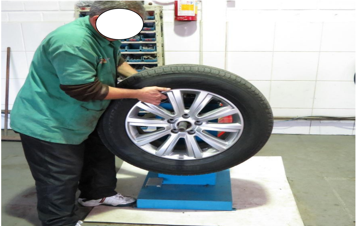
Figura 8 - Conjunto roda/pneu já acoplado na balanceadora Fonte: O Autor (2013)
