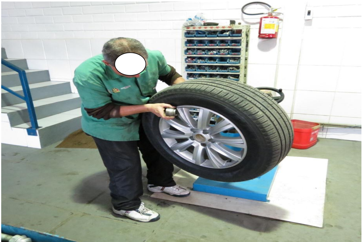
Figura 7 - Acoplado o conjunto roda/pneu na balanceadora. Fonte: O Autor (2013)
