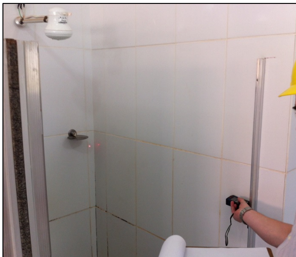
FIGURA 11: MEDIÇÃO DA ÁREA DOS CHUVEIROS
