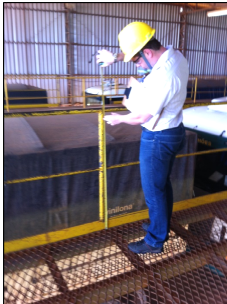
FIGURA 31: MEDIÇÃO DA PROTEÇÃO DE SEGURANÇA NA ÁREA DE COLOCAÇÃO E REMOÇÃO DE LONAS
