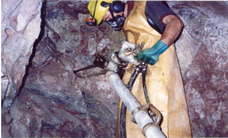
Figura 1 – Perfuratriz manual do tipo martelete pneumático
