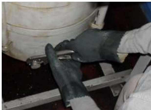
Figura 25 - Luva isolante para alta tensão. FONTE: O autor, 2014.
