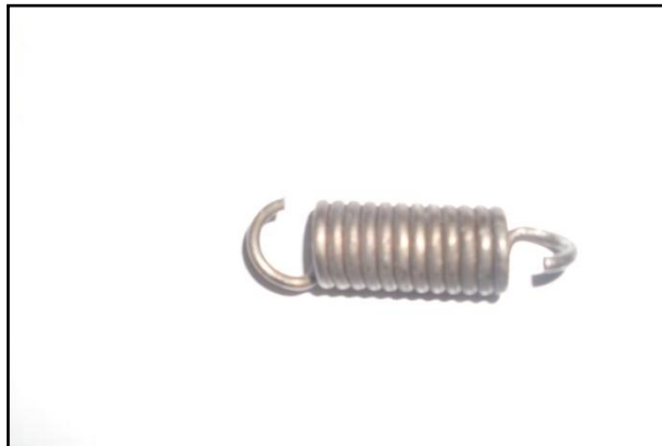
Figura 31 – Mola do Disjuntor DJ-MAQ. PAPEL 2. FONTE: O autor, 2014
