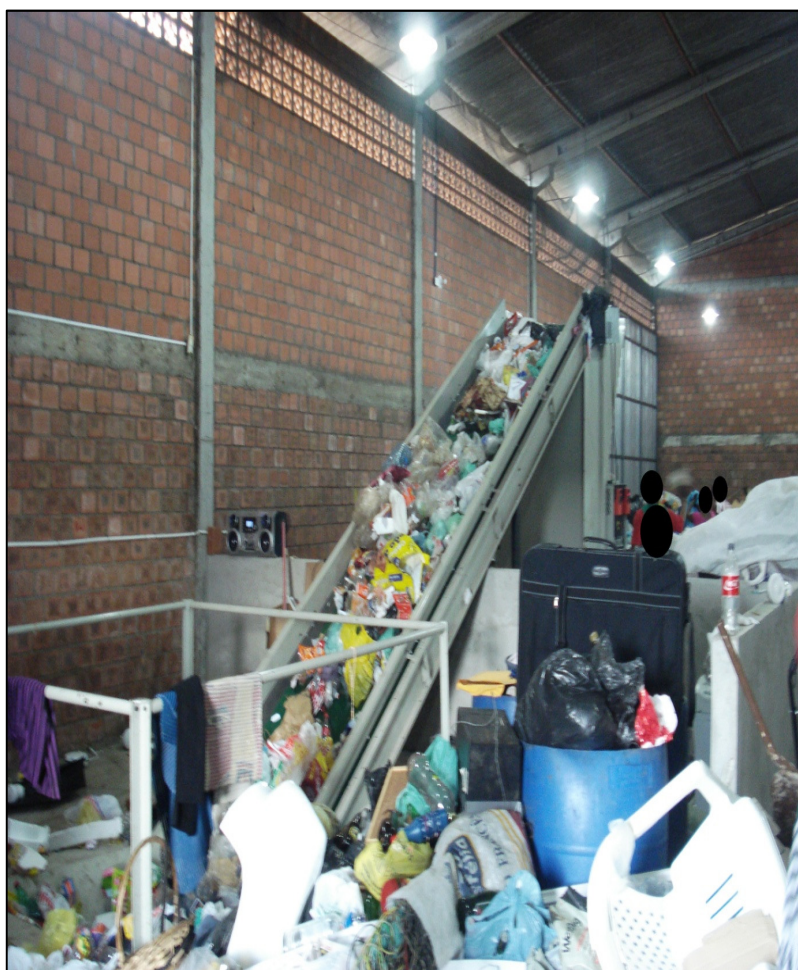
Figura 17: Esteira Elétrica sendo utilizada para a segregação de resíduos recicláveis Fonte: Autor, 2014.
