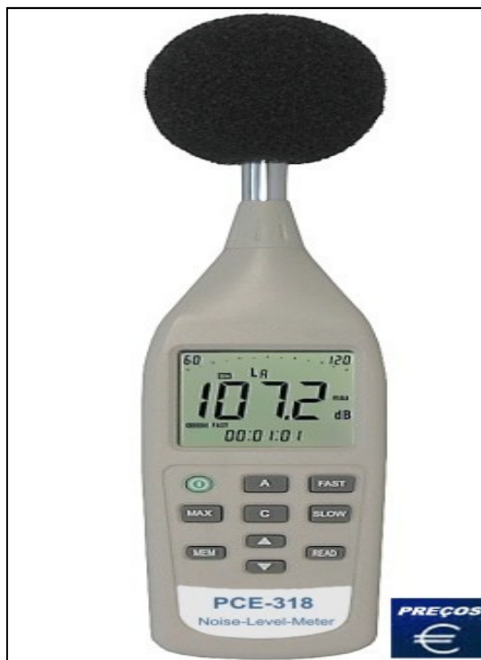
Figura 3: Decibelímetro PCE-318 Fonte: PCEMEDIDORES, 2014.
