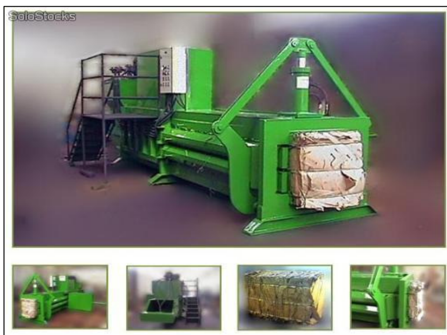
FIGURA 6: Prensa horizontal enfardadeira automatizada - alta produção Fonte: SOLOSTOCKS, 2014.
