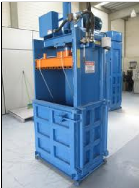
Figura 5: Prensa Fardo Eletrohidráulica – Vertical Fonte: NOWAK, 2014.
