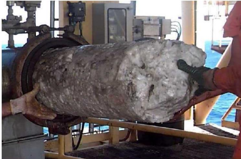
Figura 7 - Hidrato Coletado em um Recebedor em uma Instalação Marítima de Petróleo
