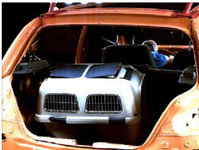
Figura 18 – Caixa de transporte após colisão Fonte : ADAC Technology Center, 2009
