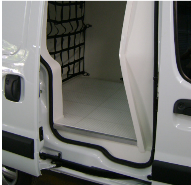
Figura 62 – Assoalho revestido em veículo B adaptado Fonte : Empresa Adaptação J, 2014
