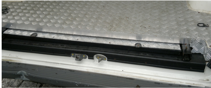
Figura 50 – Detalhe da rampa retrátil adaptada
