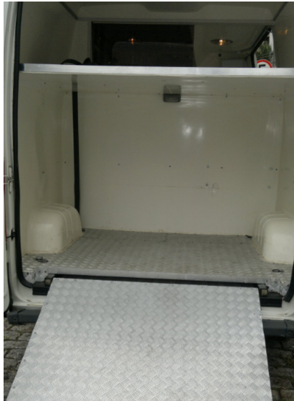
Figura 49 – Veículo adaptado com rampa Fonte : O Autor, 2014
