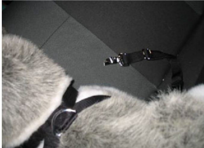
Figura 9 – Rompimento conexão cinto-guia Fonte : ADAC Technology Center, 2009
