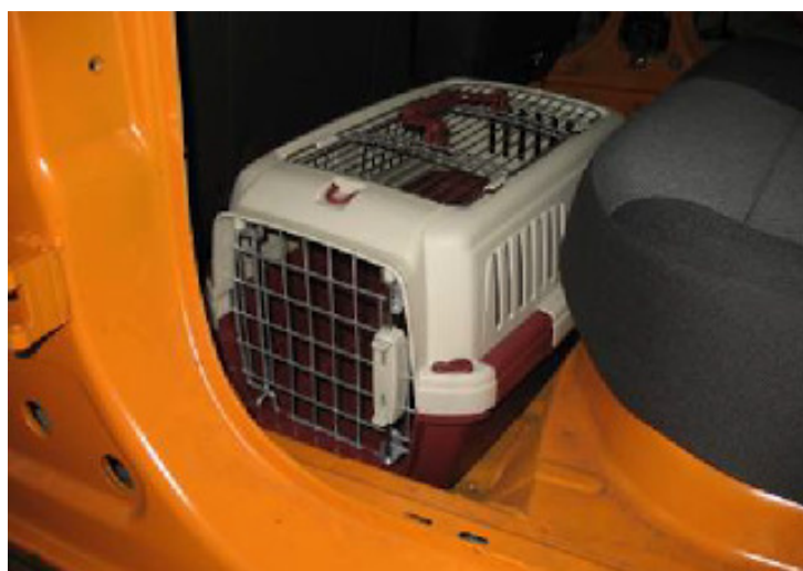
Figura 20 – Caixa no assoalho do veículo entre os bancos Fonte : ADAC Technology Center, 2009
