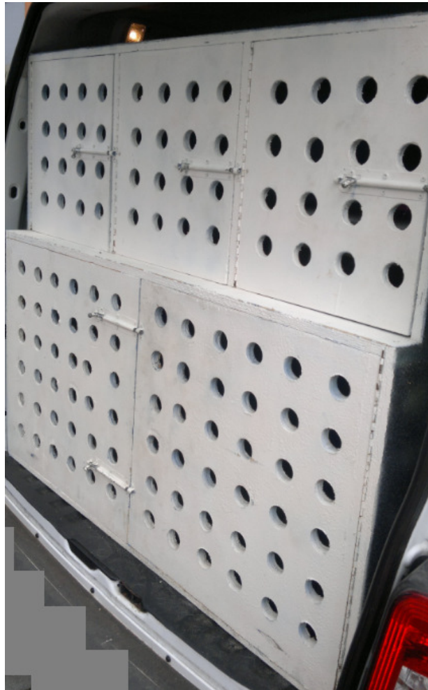
Figura 40 – Veículo adaptado com gaiolas de madeira
