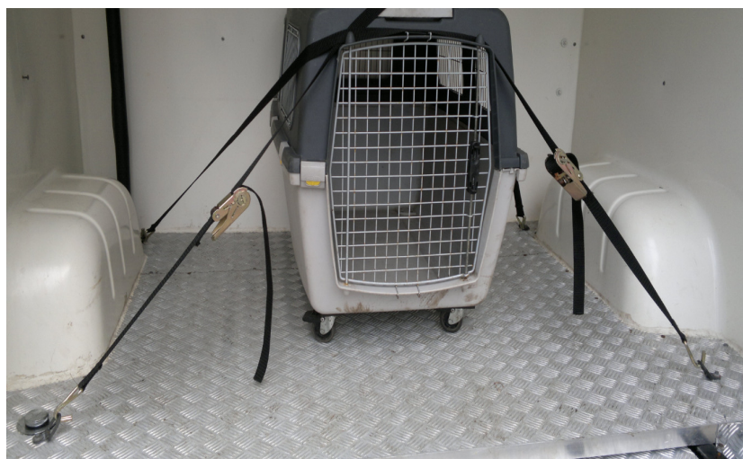
Figura 43 – Caixa de transporte presa por tiras de segurança Fonte : O Autor, 2014
