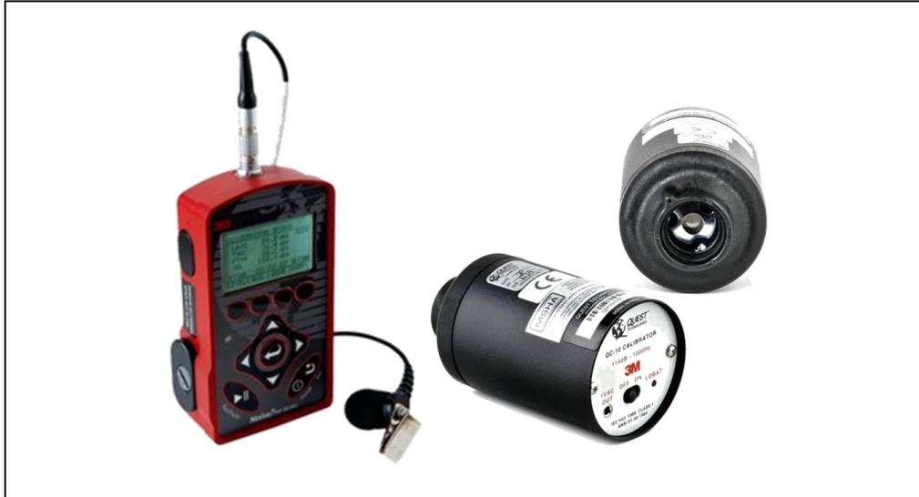
Figura 8 - Dosímetro e calibrador utilizado nas avaliações
