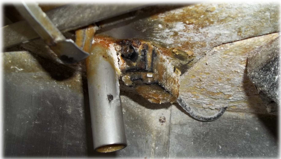
Figura 4: Detalhe do dispositivo de segurança eletromecânico de abertura.
