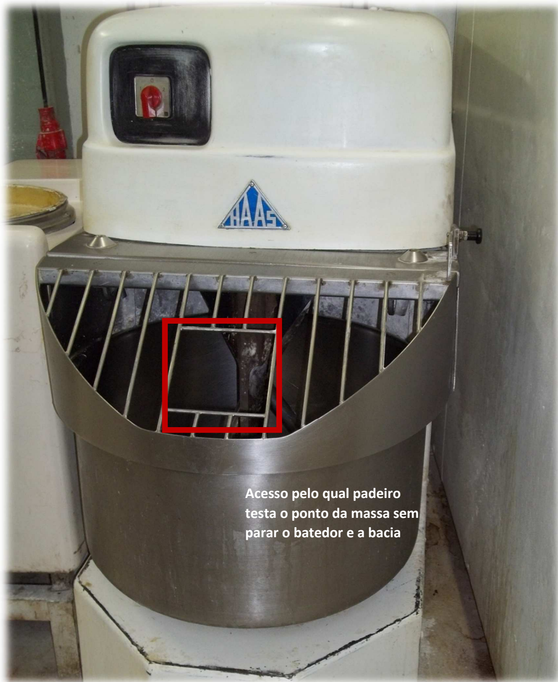
Figura 3: Amassadeira classe 2 – detalhes da bacia sem proteção, falta de botoeira de parada de emergência.
