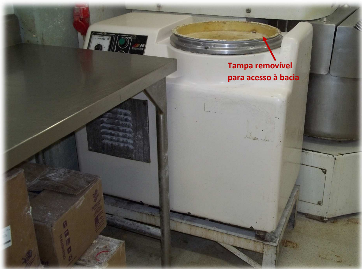
Figura 2. Amassadeira classe 1 – detalhe da tampa para acesso à bacia.
