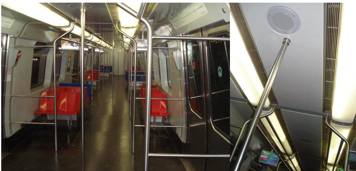
**Figura 102 - Ausência de balaústres - Sistema de som**
