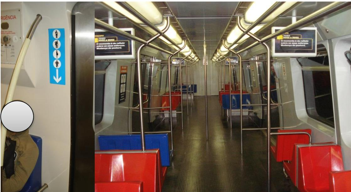
**Figura 107 - Cores de assentos preferenciais e adesivos com indicação de tipo de assento**
