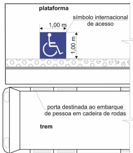
**Figura 93 - Sinalização visual no piso, no local de embarque, para a pessoa com deficiência ou com mobilidade reduzida - Planta**
