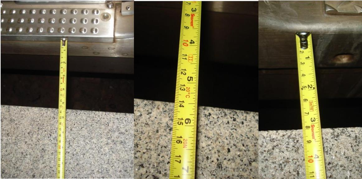
**Figura 48 - Vão entre trem e plataforma**
