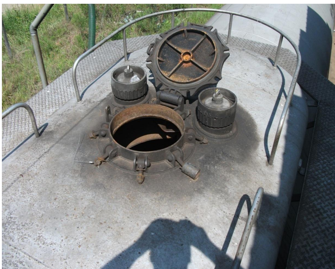
Figura 7: Tampa superior do vagão tanque ferroviário.
