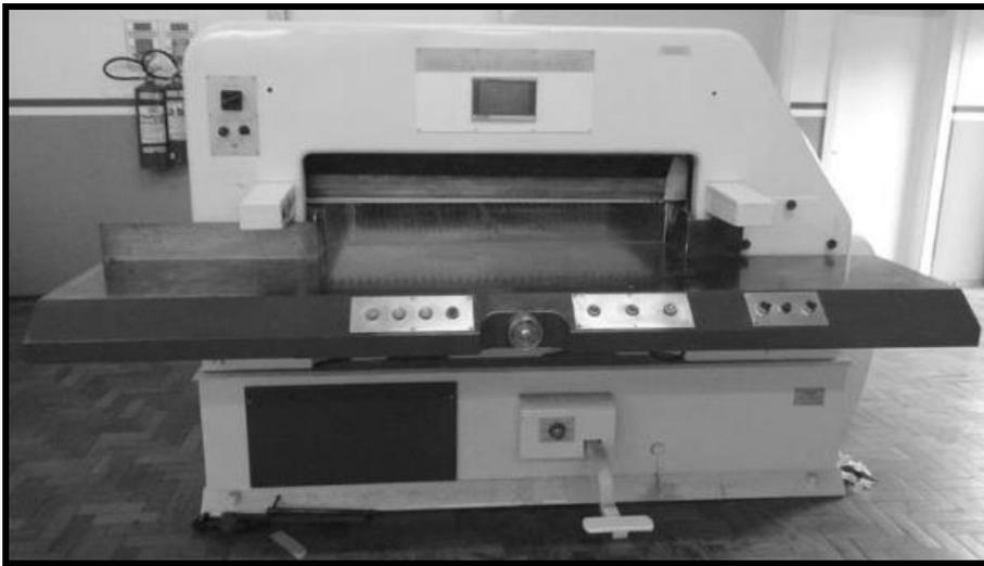
Figura 6 – Prensa Hidráulica para corte, fabricada em 2007
