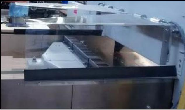
Figura 15 - Proteção fixa lateral da mesa do esquadro.
