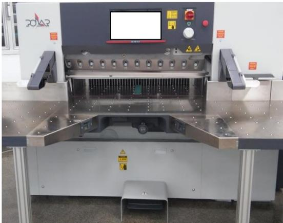
Figura 13 - Botão de parada de emergência devidamente instalado e sinalizado.
