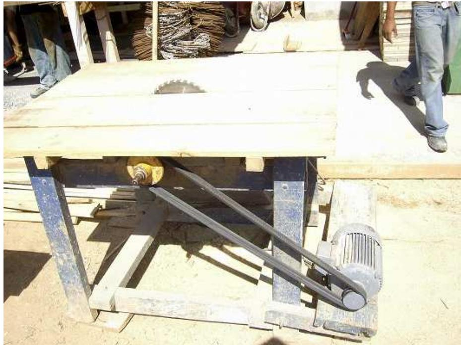
**Figura 5** – Serra circular de bancada sem proteções.
