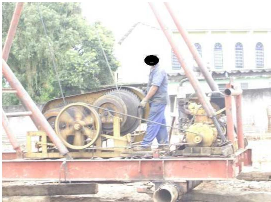
**Figura 4** – Máquina de bate-estacas sem proteção.
