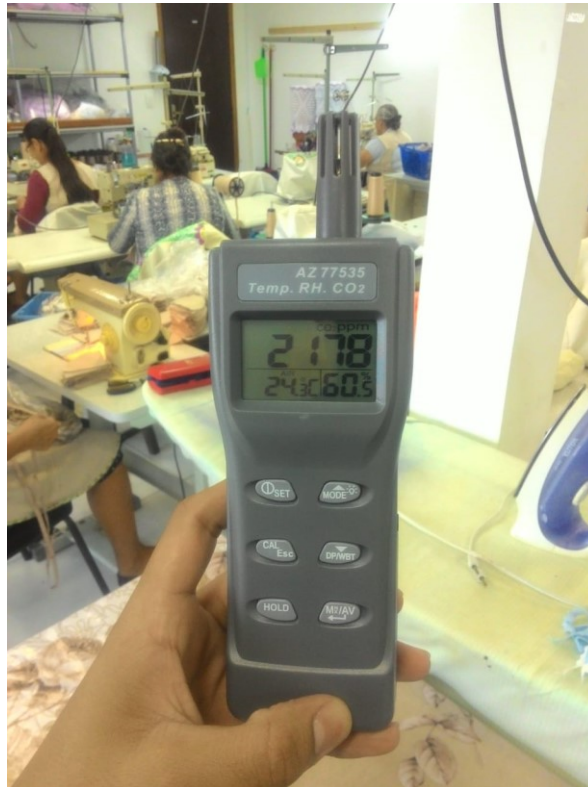
Figura 15- Foto do termohigrômetro AZ-77535 FONTE: O Próprio Autor (2019).
